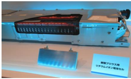
新型プリウスに使われているニッケル系リチウムイオン電池。最も高容量だが安全性が課題だった。今回見事にクリア
